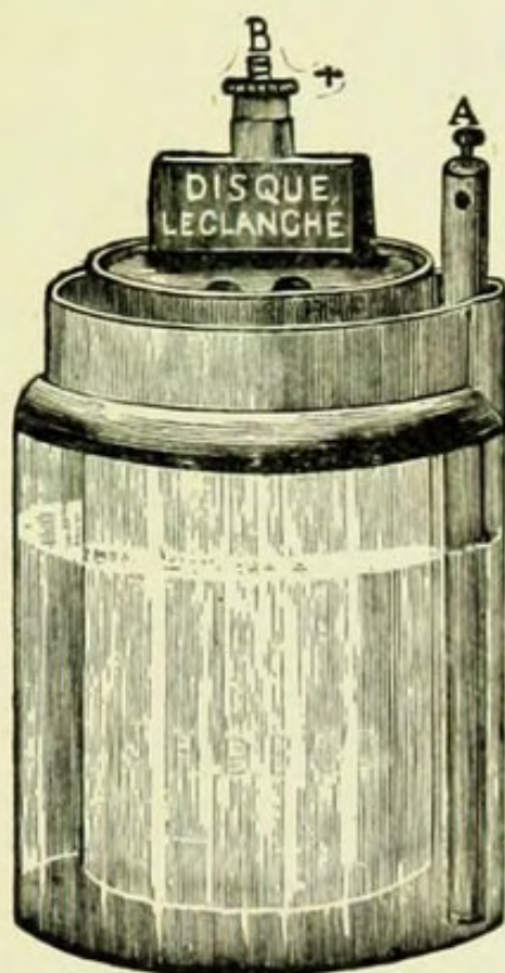
FIG. 6.—LECLANCHÉ VOLTAIC CELL.
